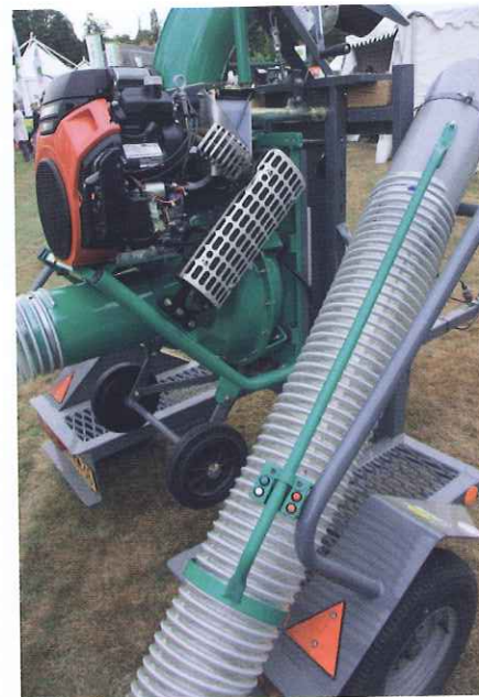
Gruau Espaces Verts propose sur de nombreuses machines un système de commande sans fil grâce auquel l'utilisateur fait tourner son moteur selon différents régimes préenregistrés (ralenti, mi-accélééré, accéléré) afin de réduire le niveau sonore lorsque l'appareil ne doit pas fonctionner à plein régime. Ce dispositif induit aussi une baisse de la consommation de carburant.
