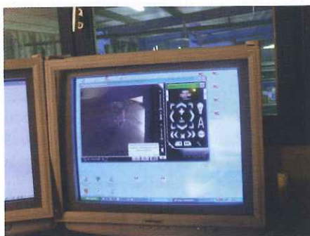
Du bureau d'études, il est possible de vérifier le travail du centre de découpe laser grâce à une caméra montée sur rail. Sur la droite, étude sur une remorque.
