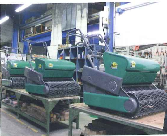
La chaîne de montage, ici avec des engazonneuses. Les différents sous-ensembles des matériels sont produits à l'avance. Ensuite, le constructeur peut lancer des petites séries.
