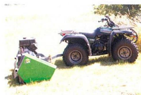
Attelé à l'arrière d'un quad, son rouleau arrière et ses couteaux Y permettent de passer sur des terrains irréguliers.
