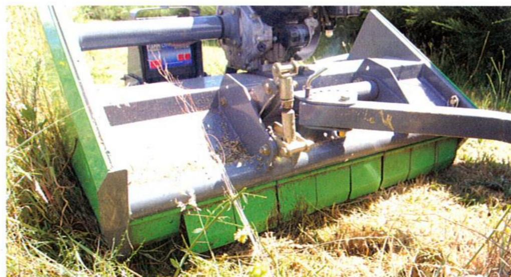
L'angle du timon est réglable, tout comme la hauteur de travail. Les plaques mobiles de tôle anti-projection allient résistance et efficacité.
