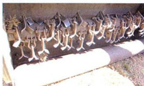
Le rotor équipé de 48 couteaux montés sur manilles apporte un broyage régulier et sécuritaire en cas d'impact avec des pierres.
